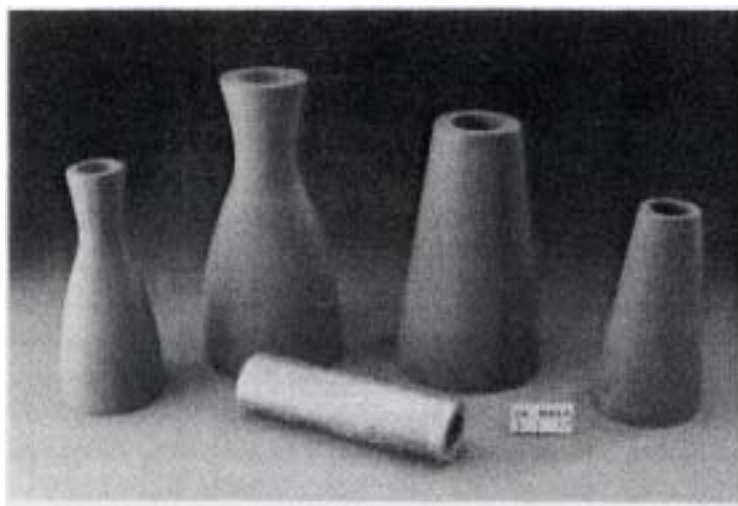
図3.4-4 木材から作製した SiSiC 系複合材料の製品例
